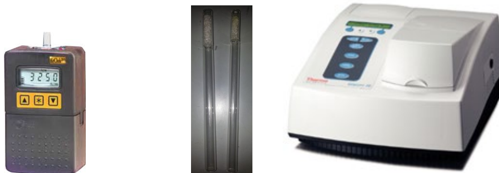
Зураг 3.5. а) агаар соруулах насос б) зориулалтын шингээгч гуурс в) спектрофотометр
