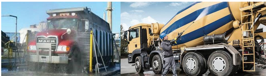
Зураг 4.1. Ачаа тээврийн үйл ажиллагааны аюулгүй байдлын ерөнхий шаардлага /машин механизмын дугуй угаах 2 төрөл/
